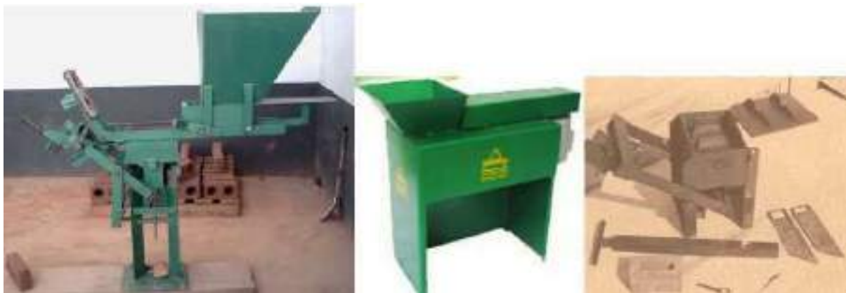
Prensa hidráulica con tolva: fabrica 1500 bloques diarios.
